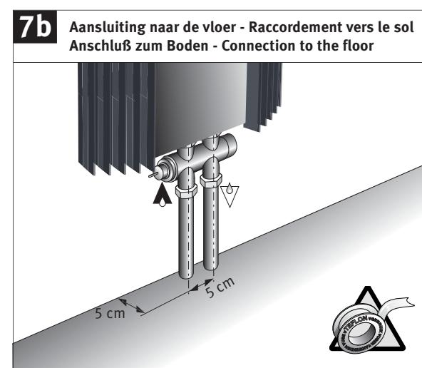
Eenpijp-tweepipaansluiting - Raccordement monotube-bitube
