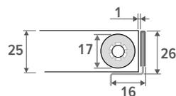
La largeur de la grille est inférieure de 4 mm et la longueur est inférieure de 2 mm à la largeur et à la longueur du Mini Canal Pro.
