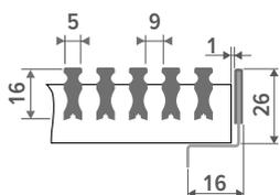
*La largeur de la grille est inférieure de 4 mm et la longueur est inférieure de 2 mm à la largeur et à la longueur du Mini Canal Pro.*
