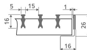
La largeur de la grille est inférieure de 4 mm et la longueur est inférieure de 2 mm à la largeur et à la longueur du Mini Canal Pro.
