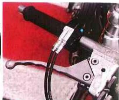
Les bracelets avec supports leviers intégrés des années 60. Sur la cocotte de tirage, le scotch évite la rotation des tondeurs de câbles. Le levier tire les câbles sur la même longueur grâce à une potence.
