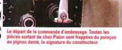
Le départ de la commande d'embrayage. Toutes les pièces sortant de chez Paton sont frappées du poinçon au pignon denté, la signature du constructeur.
