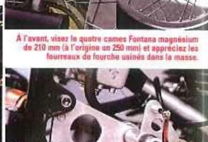
À l'avant, visez les quatre cames Fontana magnésium de 210 mm (à l'origine on 250 mm) et appréciez les fourreaux de fourche usinés dans la masse.
