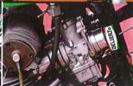
Les carburateurs Dell'Orto de 40 ont demandé une grosse mise au point au banc. De longues pipes (plus de couple) et des trompes courtes assurent un bon compromis.
