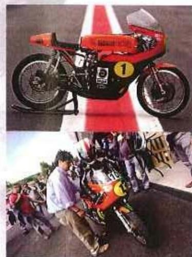
Orange sur le flanc droit, c'est la Paton 2006 assaïée. On remarque le reniflard avec récupérateur sous la selle. Sur le réservoir un fibre de verre, le sigle Paton, constitué d'une cascade de cinq pignons.
