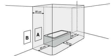
En la **zona A** se puede instalar un radiador eléctrico de clase de aislamiento II. La toma de corriente debe colocarse a una altura mínima de 25 cm por encima del suelo. El radiador no debe instalarse nunca por debajo del enchufe. En la **zona B**, un radiador eléctrico de clase de aislamiento II puede conectarse a la red eléctrica a través de un enchufe situado en la **zona B**.
