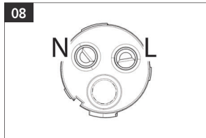
08 Sluit de kabels correct aan in de kern.
