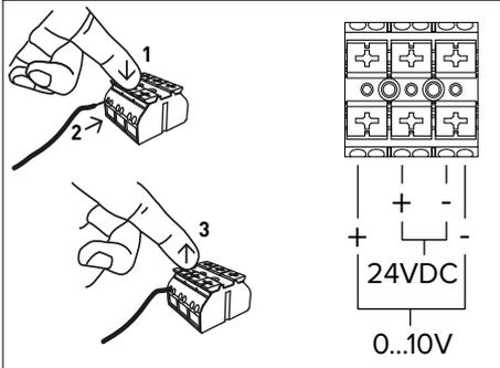
En el lado de la conexión hidráulica se encuentra también la regleta para la conexión eléctrica. La conexión eléctrica se conecta al bloque negro, que se encuentra en la parte inferior de la cubierta protectora.
