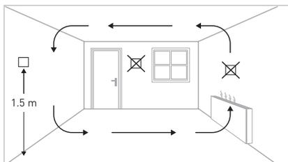
Installez le thermostat d'ambiance à environ 1.5 m du sol, contre un mur intérieur, si possible face à la source de chauffage. Évitez les murs extérieurs et les courants d'air des fenêtres et des portes, la lumière directe du soleil et autres sources de chaleur comme les télévisions, les lampes murales ou de table, les feux ouverts, les tuyaux de chauffage, etc. Assurez-vous que le mécanisme de verrouillage situé sous le thermostat soit aisément accessible.
