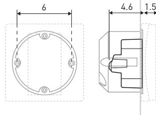
Montez le thermostat d'ambiance JRT.100 dans un boîtier d'encastrement comportant des trous de vis espacés de 60 mm pour la fixation du thermostat. Profondeur minimale de 45 mm (la profondeur dépend du câblage). La dimension interne du boîtier doit être de Ø60 mm ou 50x50 mm (au moins).
