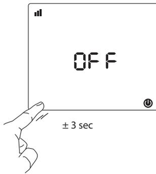
Pour entrer dans le menu des paramètres, appuyez sur le coin inférieur gauche de l'écran pendant 3 secondes, jusqu'à ce que "01" apparaisse.
