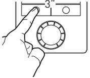
Lassen Sie die Tasten los und drücken Sie innerhalb von zwei Sekunden auf die linke Taste, und zwar länger als 3 Sekunden.
