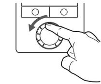
Drehen Sie den Drehschalter mindestens um 90 ° entgegen dem Uhrzeigersinn. "P.." wird im Display angezeigt.
