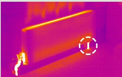
Auf den hier gezeigten Bildern (4 Minuten nach dem Start der Heizung) ist deutlich zu sehen, dass beim Low-H<sub>2</sub>O-Heizkörper sowohl Vor- als auch Rücklauf warm sind. Der Low-H<sub>2</sub>O-Heizkörper ist vollständig aufgewärmt und verteilt diese Wärme im Raum.
