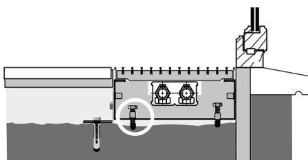
L'option de réglage en hauteur est toujours équipée de vis de réglage supplémentaires, de sorte que le caniveau peut être installé tout contre la fenêtre.
