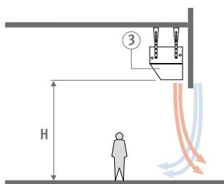
Afin d'éviter l'entrée d'air frais à proximité des portes, il est possible de monter une bouche de soufflage.
