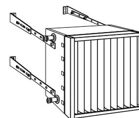
Dans les locaux étroits, il y a lieu de placer une grille à double déflexion afin d'éviter une trop haute température sur le mur opposé. Les ailettes sont montées dans les sens vertical et horizontal.
