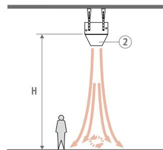
Dans le cas de plafonds d'une hauteur supérieure à 6 mètres, un cône de soufflage doit être monté.
