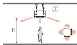
Dans le cas de plafonds trop bas, une meilleure diffusion horizontale sera obtenue à l'aide d'un diffuseur à 4 directions.
