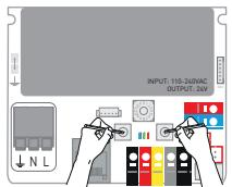
2. Enfoncez simultanément les boutons [-] et [+] du circuit imprimé et remettez sous tension. Le LED bleu s'allume, le LED vert s'allume 2 secondes plus tard et le LED rouge après 4 secondes. Relâchez la pression sur les boutons dès que les 3 LED clignotent..
