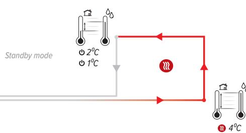
L'appareil passe automatiquement en mode refroidissement, dès que la température de l'eau est de 4°C inférieure à la température ambiante. Lorsque la différence de température d'eau est inférieure de 2°C sous la température ambiante, l'appareil se remet automatiquement en standby.
