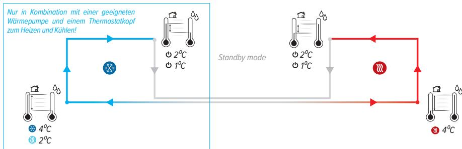
Das Gerät wechselt automatisch in den Kühlmodus, sobald die Wassertemperatur 4°C unter der Raumtemperatur liegt. Wenn die Wassertemperatur weniger als 2°C unter der Raumtemperatur liegt, kehrt das Gerät automatisch in den Standby-Modus zurück.
