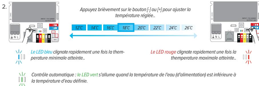
3. Régler l'arrêt : enfoncez le bouton [-] du circuit imprimé jusqu'à ce que **le LED bleu** clignote 5x et relâchez.
