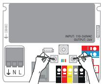
2. Halten Sie beide Tasten [-] und [+] gedrückt, und schalten Sie die Spannung zurück ein. Die **blaue LED** leuchtet. Nach 2 Sek. leuchtet die **grüne LED** auf und 4 Sek. später leuchtet die **rote LED** auf. Lassen Sie die Tasten los, sobald alle 3 LEDs blinken..
