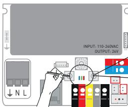
Fehlersensor [Tw of To] - Überprüfen Sie den Wassertemperatursensor
